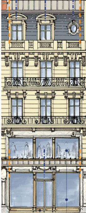
Entrée commerce - Devanture à deux niveaux pour cet entresol commercial
