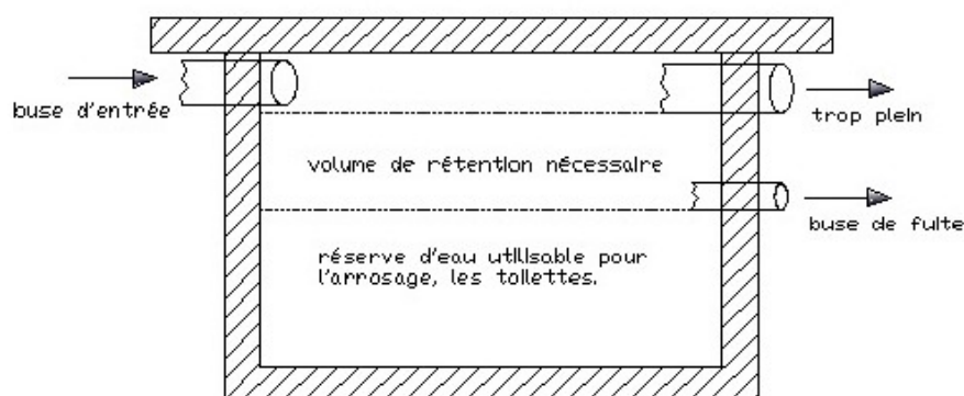
Coupe type d'un bassin de rétention enterré aménagé en citerne
