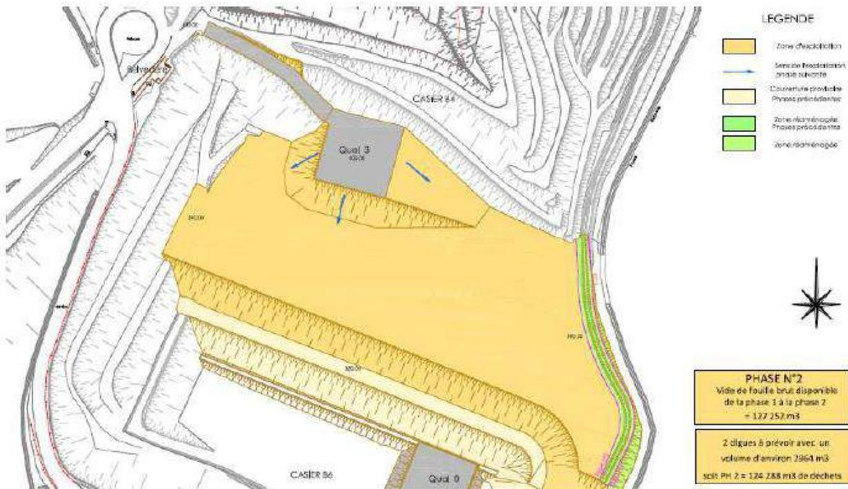
Photo 13 : plan prévisionnel de la phase 2 de l'exploitation du casier B5 sur la période 2015 – 2016
