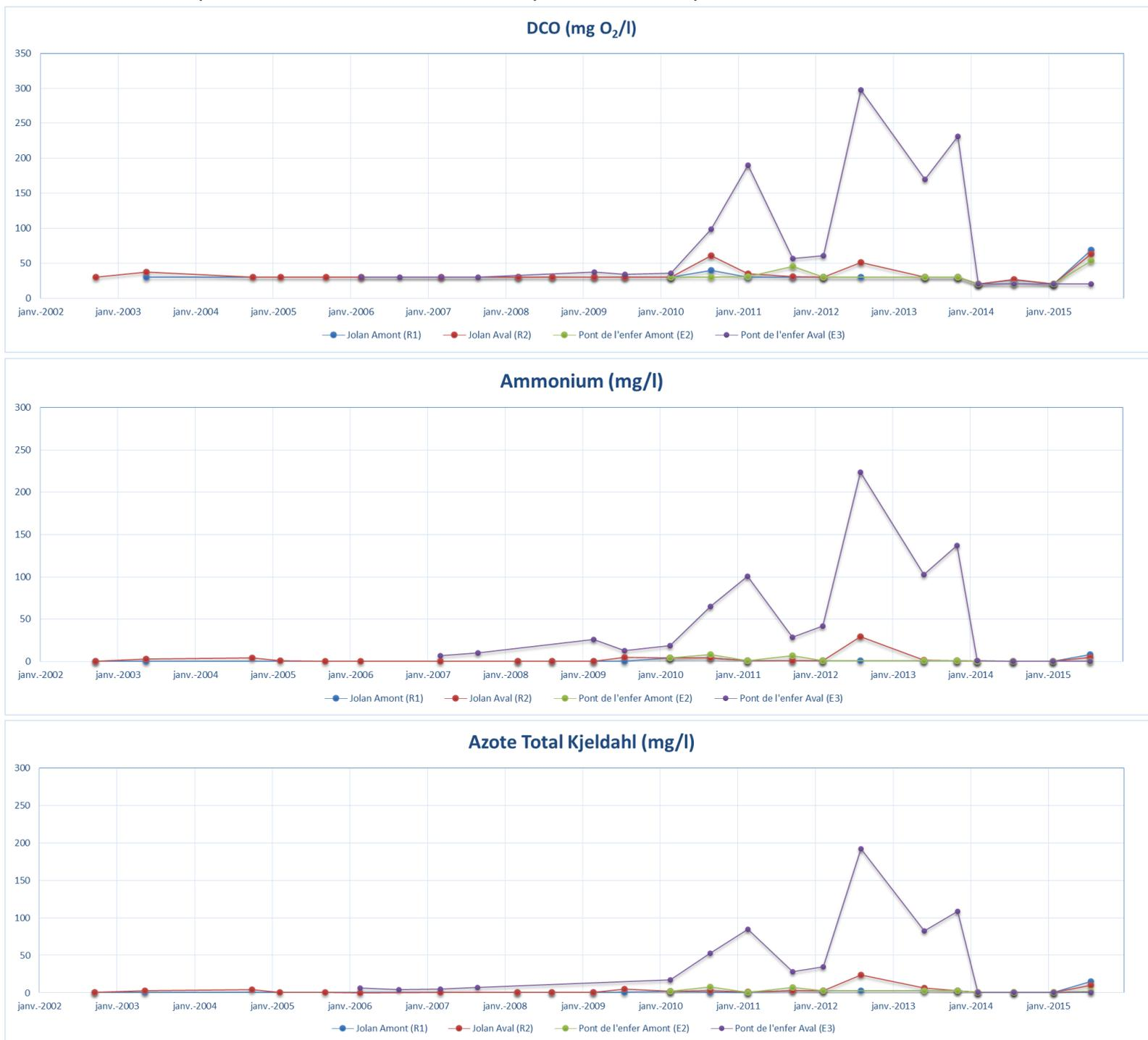
Figure n° 25 : Evolution de la DCO, de NTK et de NH<sub>4</sub> en amont et en aval du Jolan et du Pont de l'Enfer
